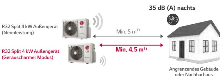
Schalldruckpegel<sup>2)</sup> je nach Entfernung vom Gerät
